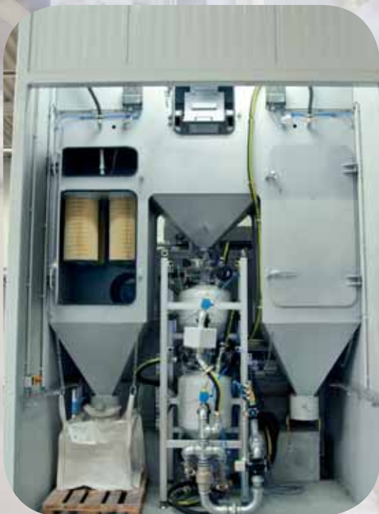
Doppelkammer-Druckstrahlssystem zum unterbrechnungsfreien Strahlen
