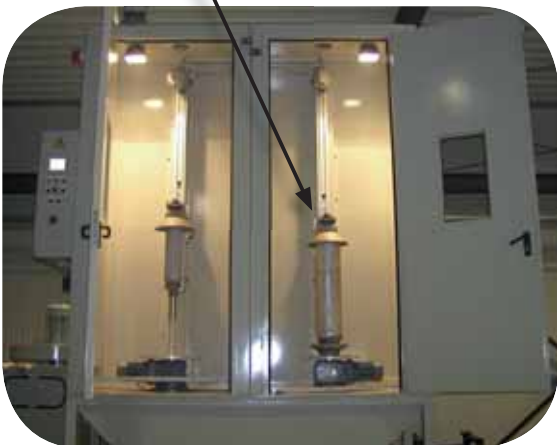
Strahldüsen im Einsatz in einer Rohrrinnenstrahlanlage zu Strahlen von Gas- und Taucherflaschen
