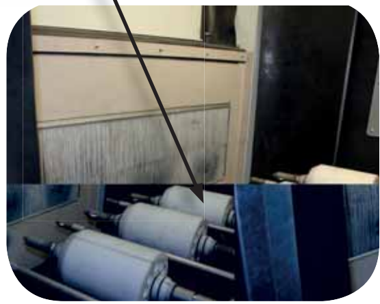
Strahlzangen im Einsatz in einer SES Rohrrinnenstrahlanlage für Pipelines
