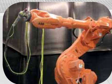
Robotergeführte Stahldüse für automatisierte Strahlarbeiten
