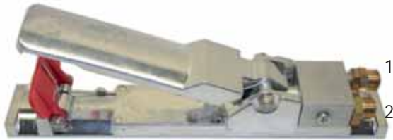
Totmannschalter pneumatisch (1) (2) Bei einpoliger Version ist Anschluss 2 mit einem Blindstopfen versehen
